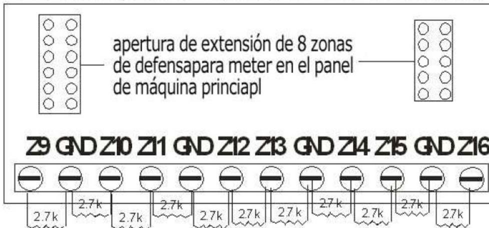
Z9 ~ Z16 significa 9-16 extremo de conexión del cable de las zonas de protección.
